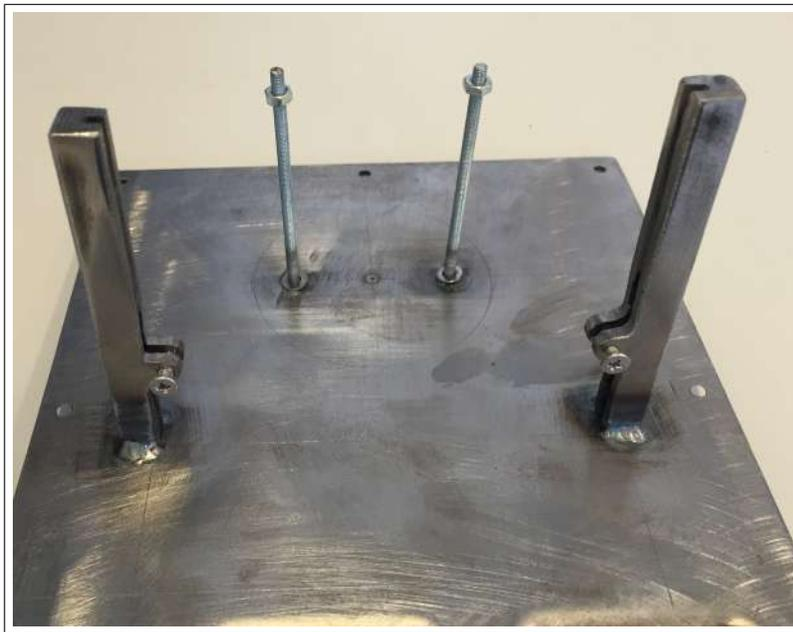
**Abbildung 5.2.3:** Halterung ohne Platine
