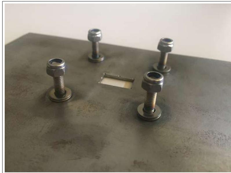
**Abbildung 5.2.2:** Gewindestangen für die Sensorplatine
